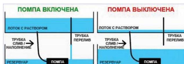
Рис.4: Система периодического затопления
